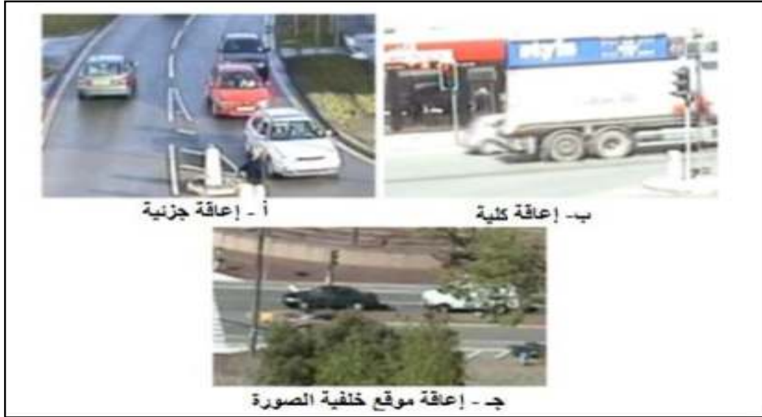
شكل 6.2: أنواع مختلفة من الانسداد للمركبة [94]
